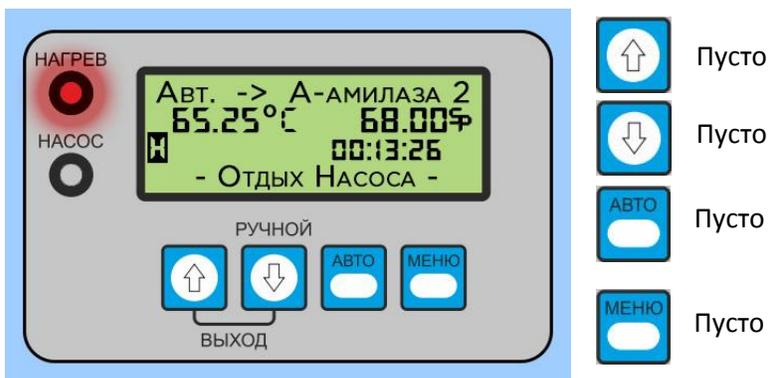
Когда начинается период отдыха — звучит звуковой сигнал, и на дисплее отображается индикация состояния насоса. Для каждого шага запускается таймер обратного отсчёта, когда температура достигает её заданного значения. За 5 секунд до конца шага будет звучать уведомляющий сигнал.
