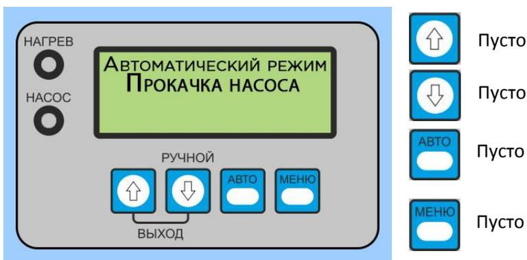
Эта операция полезна, чтобы выгнать пузырьки воздуха вокруг контуров и крыльчаток насоса. В конце этой фазы запускается насос, и вода рециркулирует.
